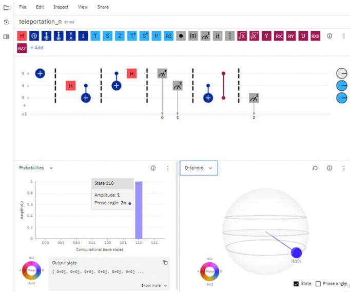
Рис. 7. Схема реалізації алгоритму квантової телепортації у IBM Quantum Composer
